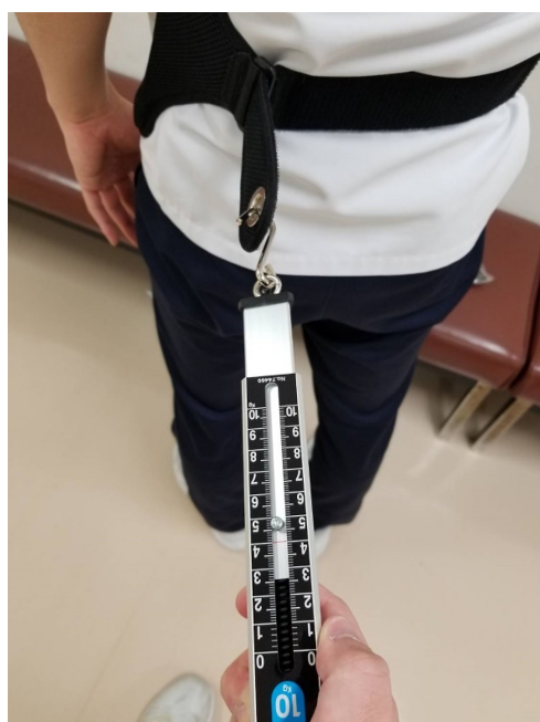
図 2. ばねばかりを使用した強度の設定方法
