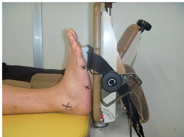
図1. HHD 受圧部の設置位置
